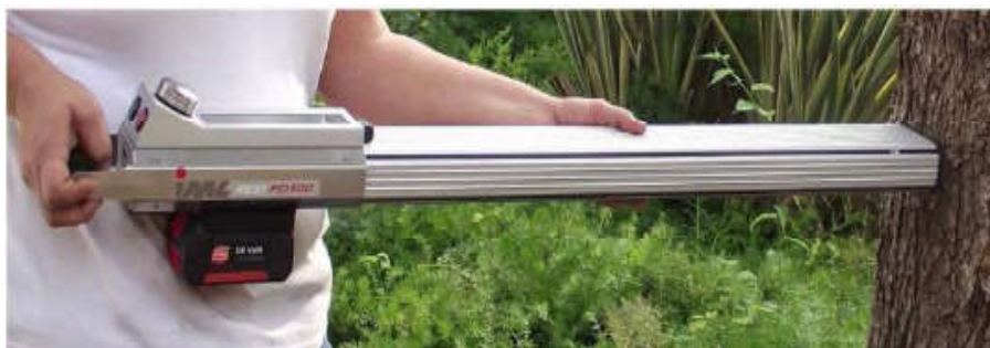
Figura 1 – Quantificação de afetações internas com recurso a resistógrafo IML RESI PD-500.
